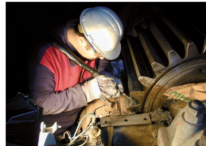
Rectificación de pittings en los flancos de los dientes de un engranaje de molino
