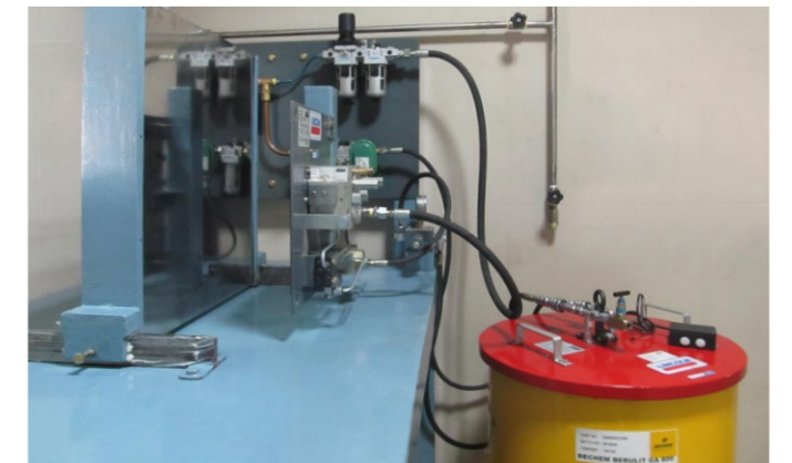
BECHEM dispone de una instalación de pruebas de pulverización para lubricantes adhesivos para simular condiciones específicas del cliente
