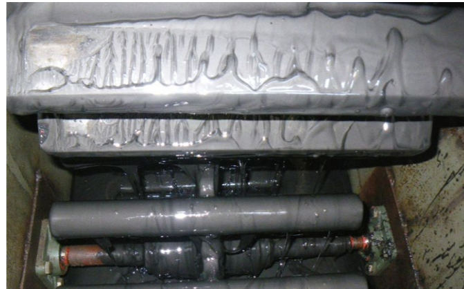
Utilización del fluido Berulit GA 2500 en un engranaje abierto con rueda de lubricación
