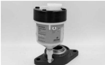
从注油器外壳上取下透明的保护盖，将边上的跳线插入预设运行时间的槽内，启动注油器。关于设置运行时间，参考6.1.1节。
