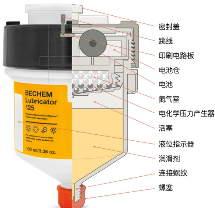
注油器的使用不受位置限制。可以目视检查液位。工作时间到期后，注油器装置需要换新。外壳耐候性好，耐腐蚀性好，在全天候浸泡下，提供良好的防水保护（IP68）。
