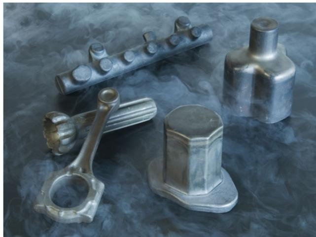
Lubrifiants de revêtement Berulit pour minimiser la formation de tartre dans les processus de formage semi-chaud
