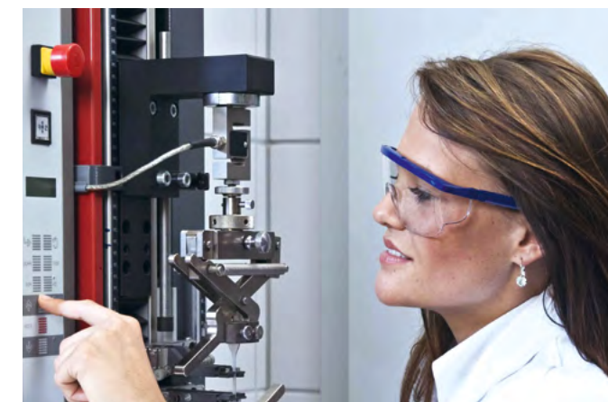
Máquina para ensayo de tracción para ensayo de resistencia de elastómeros y plásticos
