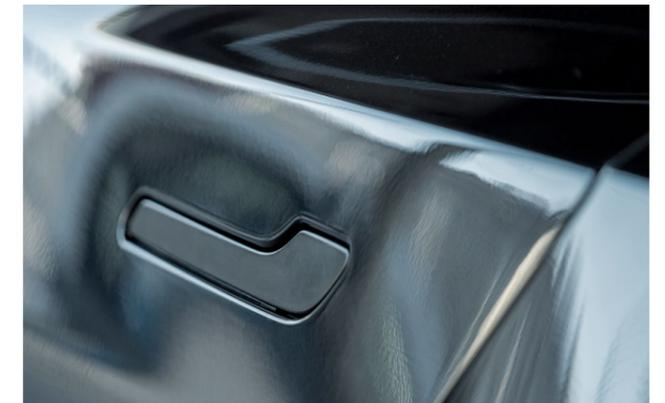
Windwiderstandsoptimierte Türklinken: Hydrophobe Beschichtungen können störenden Wassereinfluss reduzieren
