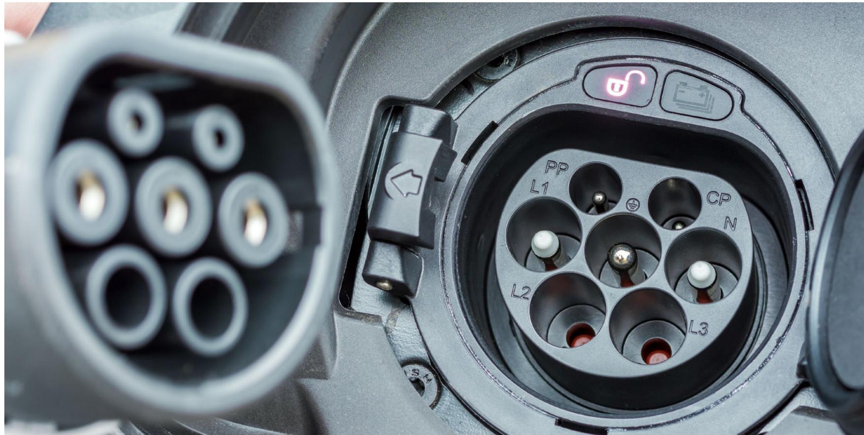
Verschleißgefahr durch hohe mechanische Einsteck- und Lösekräfte
