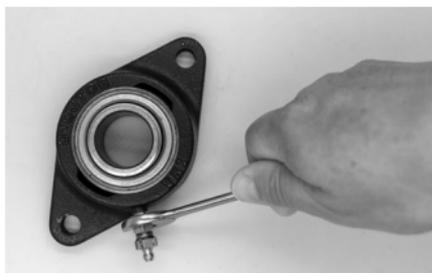
Schrauben Sie einen passenden Adapter ein (Anschlussgewinde BECHEM Lubricator 125: G 1/4). Vor Einschrauben des Schmierstoffgebers muss der Adapter vollständig mit Schmierstoff befüllt sein. Montieren Sie den Schmierstoffgeber indem Sie ihn mit einem Anzugsmoment von 6 Nm (bei 20 °C) verschrauben. Falls eine Schlauchverlängerung zur Schmierstelle zum Einsatz kommt, sollte diese vorher mit demselben BECHEM Schmierstoff befüllt werden, der sich auch im Schmierstoffgeber befindet.
