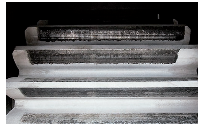
Flancos de un engranaje de horno previo al proceso de rodaje
