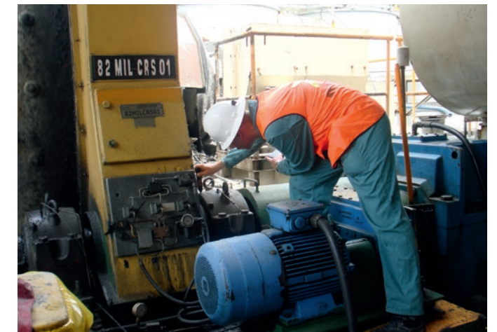
Medición de vibraciones en un engranaje de molino
