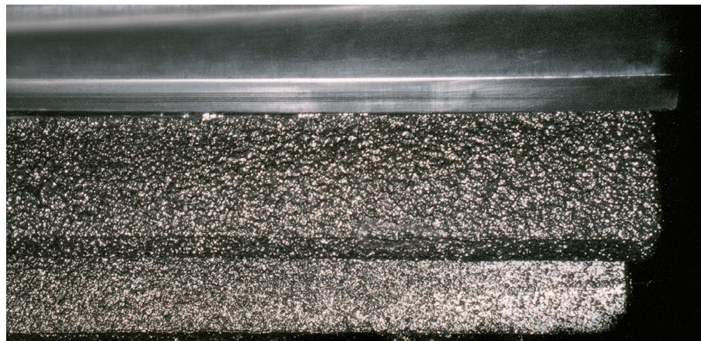
Aplicar un espesor de capa suficiente de Berulit 443 sobre el flanco de un diente
