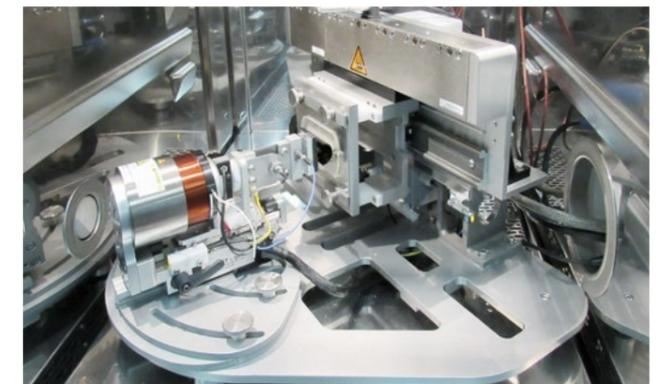
Ein zentraler Prüfstand für die Berucoat AK Reihe ist der Stick-Slip-Prüfstand, um Geräuschpotenziale ermitteln zu können. In Kombination mit einer Klimakammer können zusätzlich Einflüsse von Temperatur und Luftfeuchtigkeit simuliert werden.
