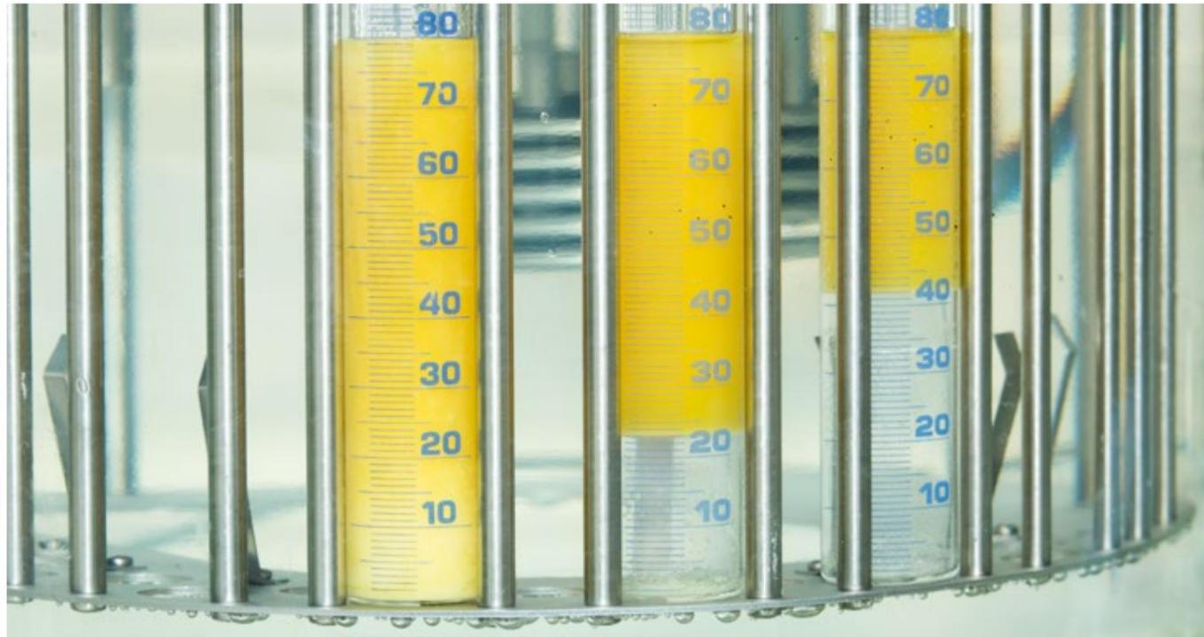
El test de laboratorio muestra la capacidad de separación de agua de diferentes aceites lubricantes pasados cinco minutos. A la izquierda se muestra el aceite de circulación no optimizado habitual en el mercado con el agua de proceso. En el centro, el aceite estándar con agua de proceso y a la derecha el aceite BECHEM Ovitol KT 460 S con un coeficiente de separación de agua excelente.
