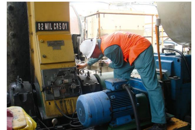
Schwingungsmessung an einem Mühlenantrieb
