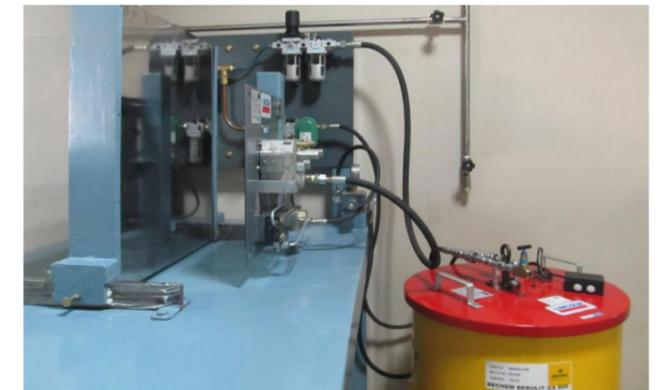
BECHEM verfügt über eine Sprühtestanlage für Haftschmierstoffe, um kundenspezifische Bedingungen zu simulieren
