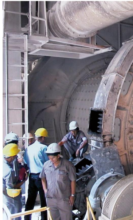
Inspektion einer Kugelmühle in einem Zementwerk
