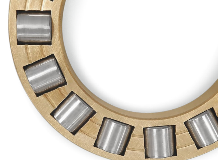
Corps de roulement et cage d'un palier FAG FE 8 après le test de fonctionnement avec huile pour engrenages Berusynth GPX
