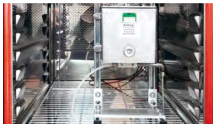
Prüfstand für die Spurkranzschmierung
