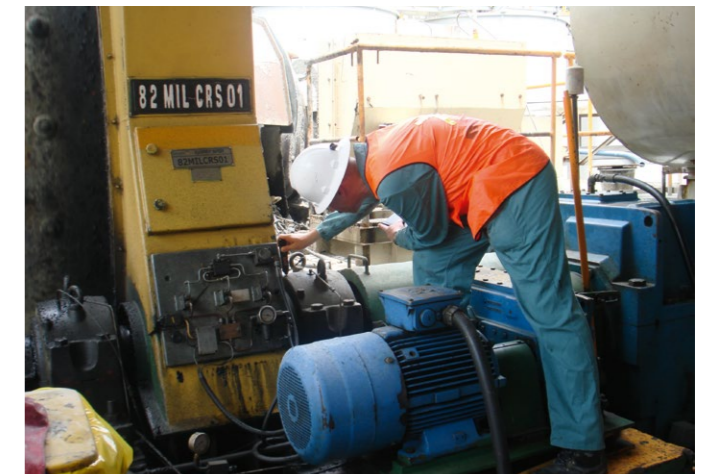
测试球磨机开齿驱动震动情况
