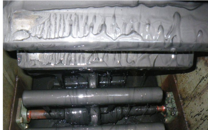
在配有浆轮的开式齿轮上使用 Berulit GA 2500 Fluid 润滑液
