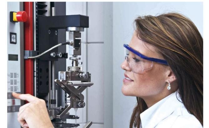
与倍可润滑剂接触的橡胶或者塑料的拉伸强度测试设备
