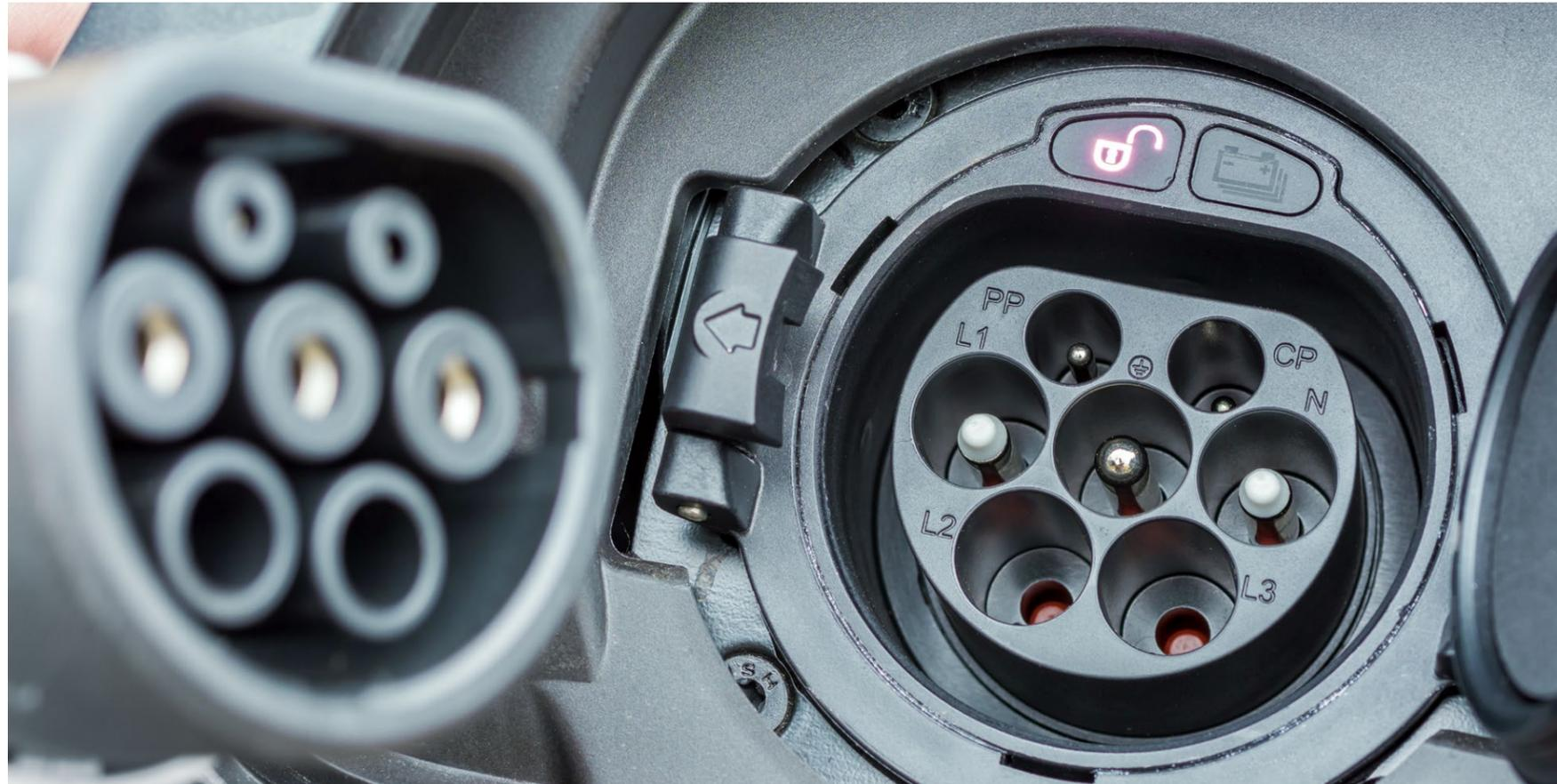
Risque d'usure dû à des forces mécaniques élevées d'insertion et de desserrage
