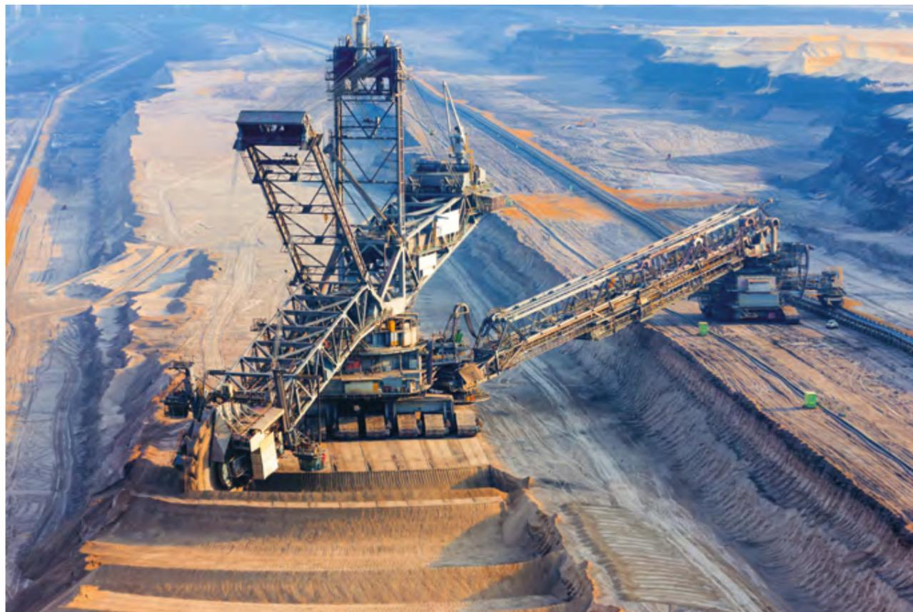
Schaufelradbagger in einer Kohlemine
