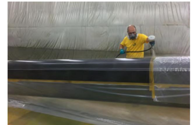
Die für das Teleskopieren mit Berucoat AF 339 beschichtete Oberfläche ist nach einer Stunde grifftrocken, nach 3 Tagen belastbar und nach 7 Tagen ausgehärtet.
