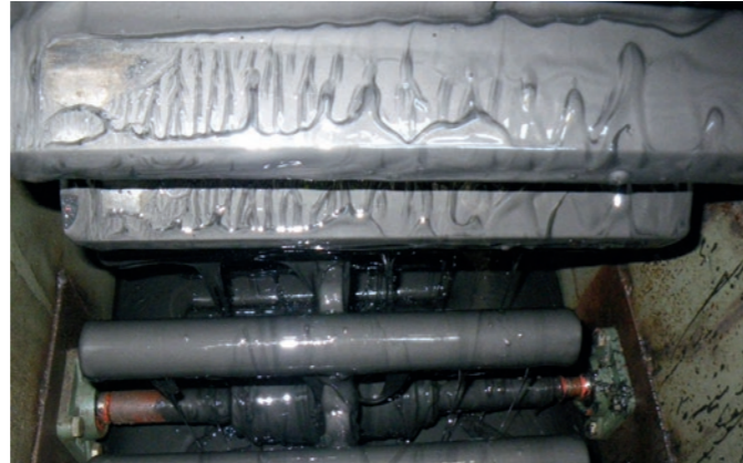
Einsatz von Berulit GA 2500 Fluid an einem offenen Antrieb mit Schmierrad
