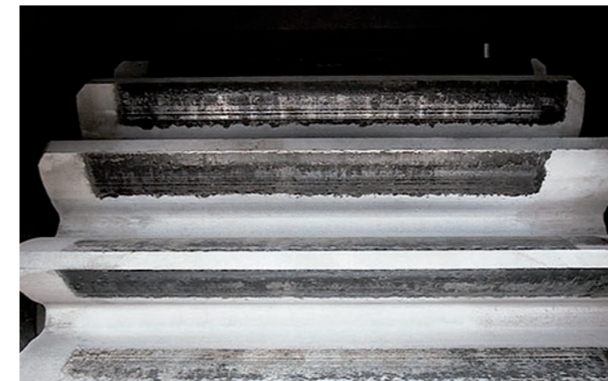
Flanken eines Ofenantriebs vor dem Einlaufprozess
