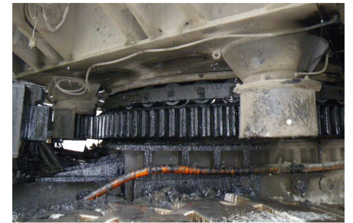
Corona dentada de una excavadora de rueda de cangilones lubricada con Berulit GA 2500
