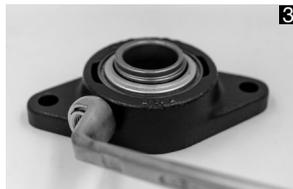
Ввинтите адаптер (соединительная резьба: G ¼). Перед ввинчиванием смазочного устройства адаптер должен быть полностью заполнен смазочным материалом.
