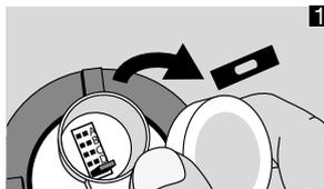
Снимите уплотнительный колпачок.
