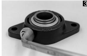
Adapter einschrauben (Anschlussgewinde
