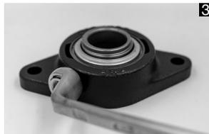
拧入适配器 (BEICHEM 注油器连接螺纹: G 3/4)。在拧入注油器之前, 适配器必须完全充满润滑剂。
