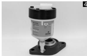
Ввинтите смазочное устройство BECHEM (момент затяжки 6 Нм при 20 °C).
