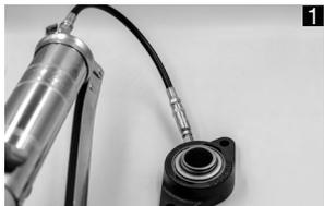
Avant le montage, prélubrifier le point de lubrification avec une pompe manuelle. Éliminer correctement les éventuelles obstructions et dépôts de résine.
