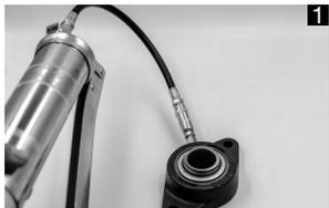
Antes del montaje, prelubricar el punto de lubricación con una pistola de engrase manual. Eliminar los posibles bloqueos y depósitos de resina de forma profesional.
