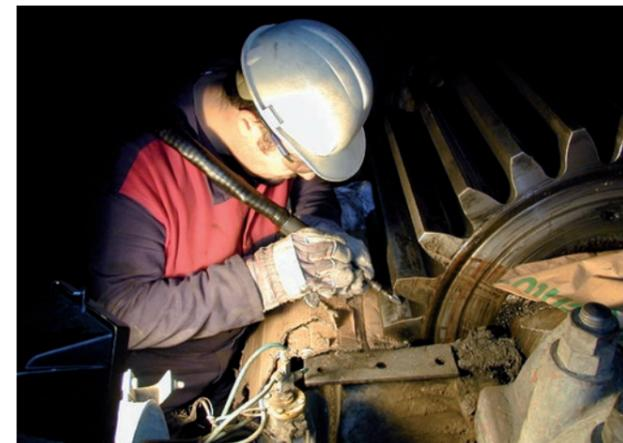
修磨球磨机开齿齿面上的点蚀痕迹
