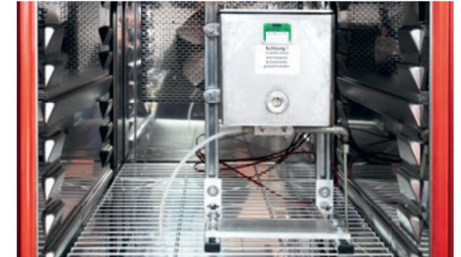
Banc d'essai pour la lubrification des boudins de roues
