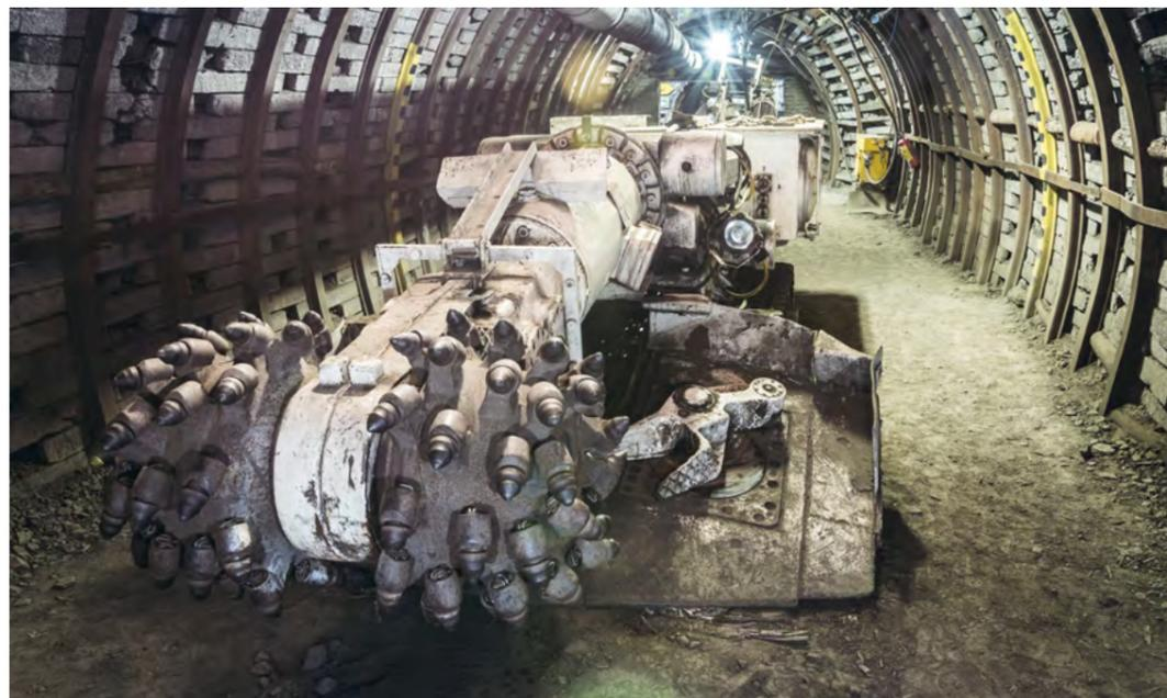
Teilschnittmaschine für den Streckenvortrieb
