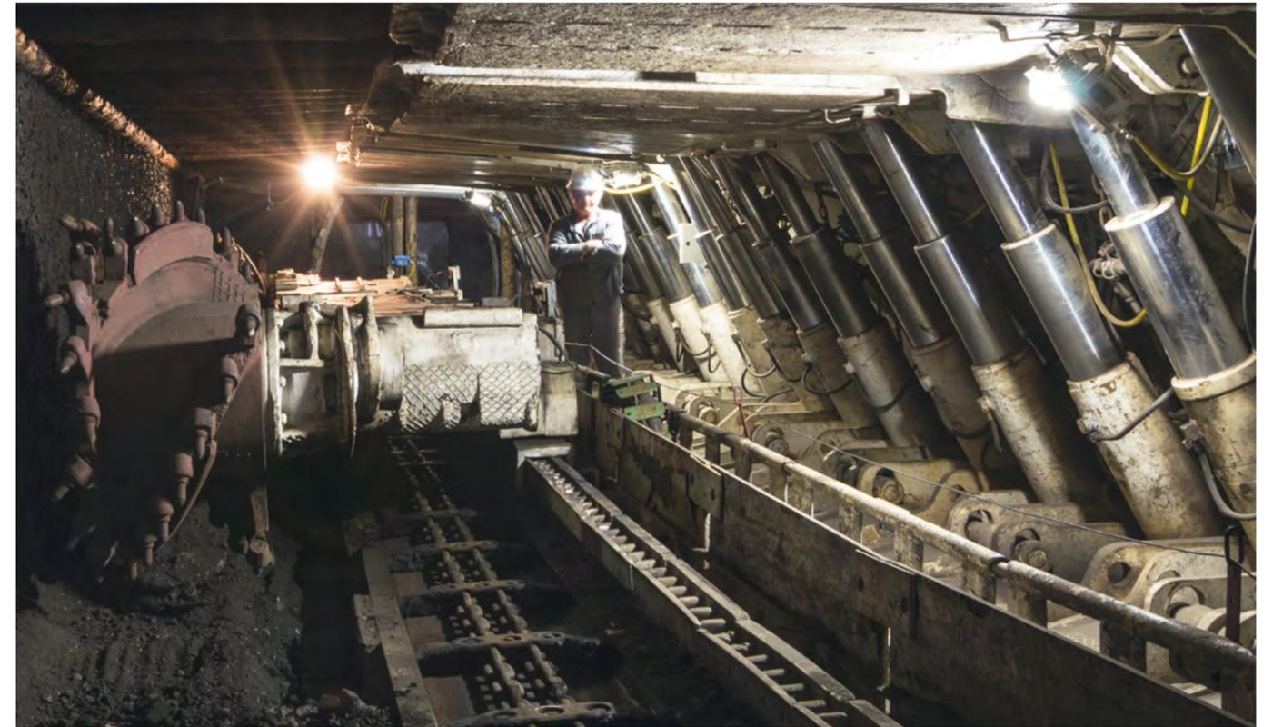
Hydraulische Ausbauschilder mit integriertem Kettenförderer und Walzenschrämlader
