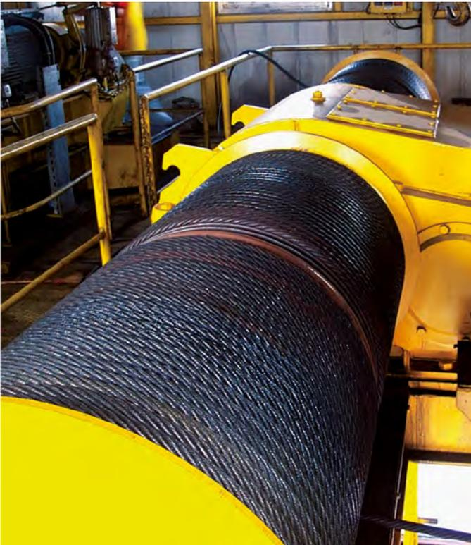
Das Seilfluid Beruprotect Rope Spray ist sehr gut für staubige Umgebungen geeignet, da es durch Ausbildung einer grifffesten Oberfläche das Anbacken von Schmutz verhindert.
